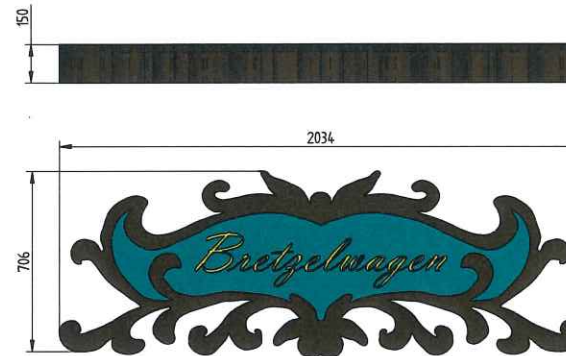
PLACA TRASEIRA MATERIAL: SAE 1020 / ASTM A36
